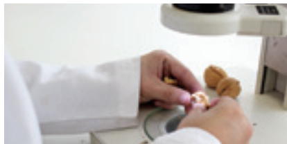
O estereomicroscópio é utilizado para a triagem de nozes importadas, visando à presença de insetos e ácaros fitófagos
