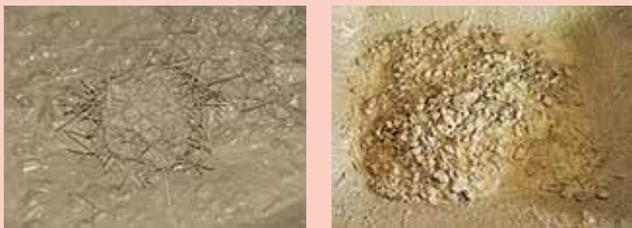
Figura 3 - Formação de grumos de fibras e segregação da mistura
