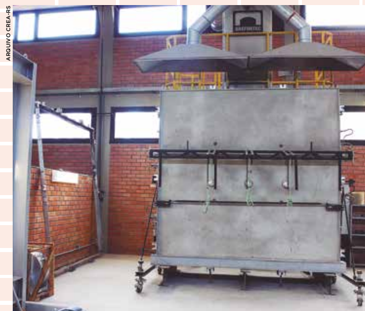
Laboratório de resistência ao fogo, conta com um forno de grande dimensões onde são realizados ensaios com elementos estruturais
