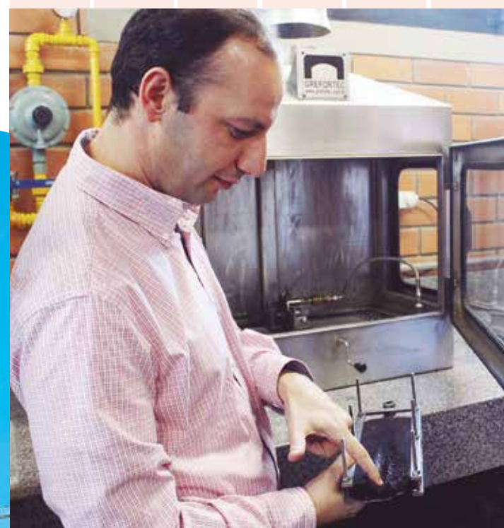
Laboratório de reação ao fogo, onde os materiais de acabamento e revestimento - como lãs de vidro e espumas - são analisados quanto à combustibilidade e ao comportamento perante as chamas, apresentado pelo professor Bernardo Tutikian, coordenador do itt Performance
