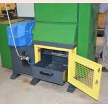
Local de saída da massa polimérica processada
