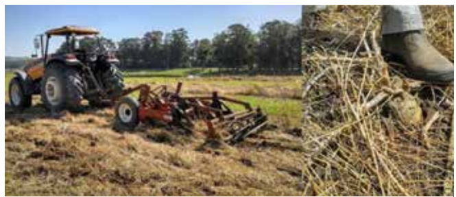
Figura 3. Escarificador munido de rolo destorreador e disco de corte de palha e raiz de nabo forrageiro semeado em baixa densidade.
