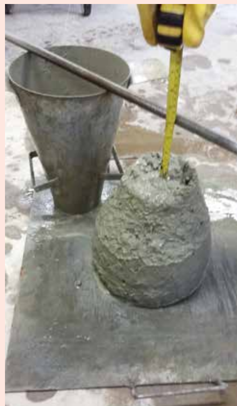
Figura 2. Abatimento de tronco de cone mantido constante 100 \pm 20 mm.
