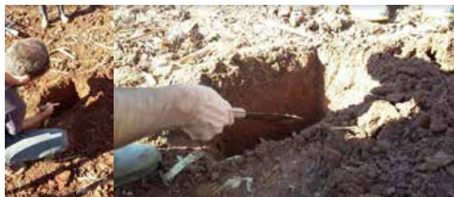
Figura 2. Identificação expedita de camada compactada no campo, em nível de produtor.
