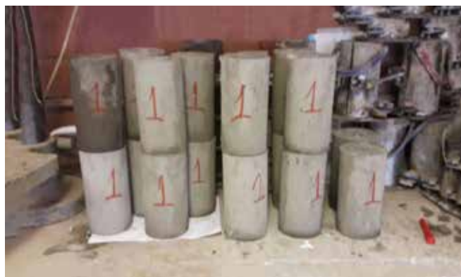
Figura 1. Corpos de prova de concreto.
