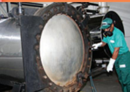
Vaso de pressão: após entrar na autoclave, os resíduos ficam expostos para injeção direta do vapor saturado que proporciona um aquecimento de 150 graus – temperatura de esterilização –, permanecendo assim por 30 min. Após, ainda dentro da autoclave, é retirada a água do condensado (que também passa por um tratamento na Estação de Tratamento de Efluentes da própria empresa) e o material passa pelo chamado pós-vácuo, para secagem do resíduo final
