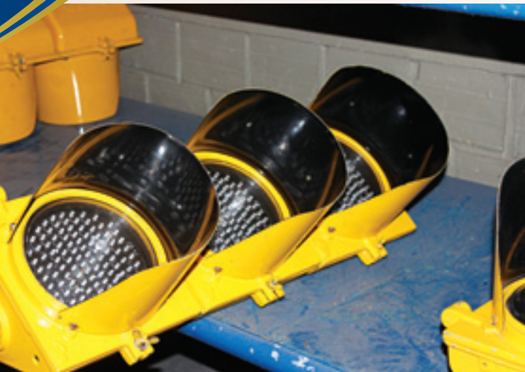
Na manutenção, as caixas dos semáforos são pintadas e as lâmpadas convencionais são substituídas por LED. Depois disso, o semáforo volta às ruas
