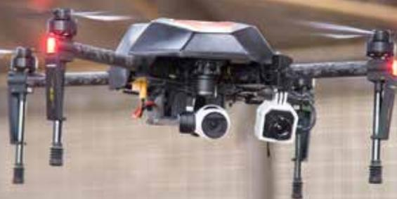
Diferentes câmeras e sensores podem ser utilizados com os drones, que diminuem os custos e riscos nas inspeções em fábricas e indústrias
