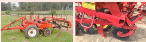
Figura 5. Escarificador com disco de corte e rolo destorreador e semeadora-adubadora de precisão com disco de corte de palhada e sulcador de adubo do tipo facão estreito
