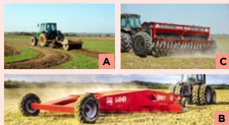
Figura 6. Taipas em lavoura de arroz irrigado (A), plaina para sistematização do solo das áreas de arroz (B) e semeadora-adubadora de fluxo contínuo (C)
