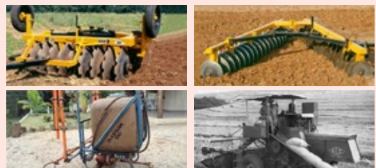
Figura 3. Grade de discos aradora e niveladora, ambas de arrasto, pulverizador de barras montado e colhedora autopropelida de grãos (sacos)
