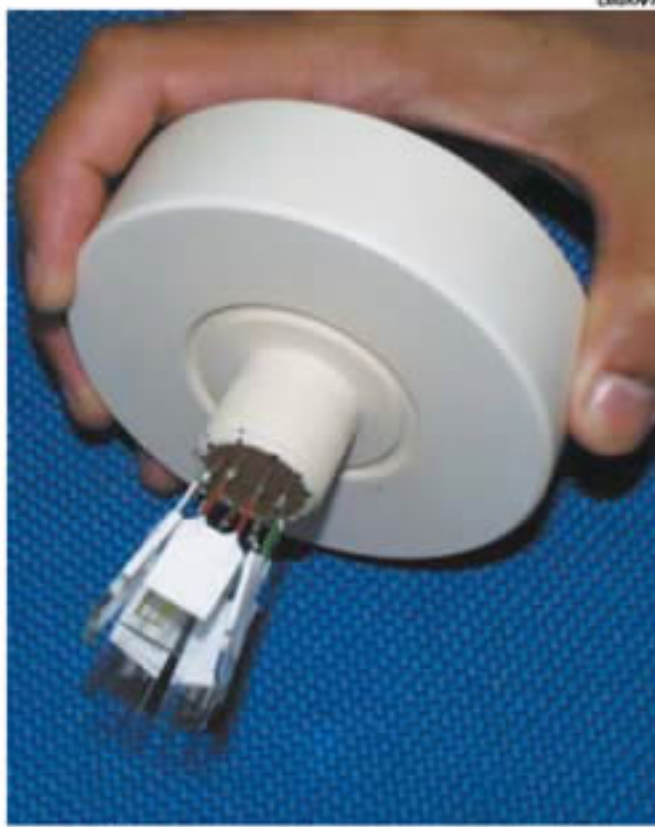
Embrapa e USP desenvolveram o equipamento para testar produtos líquidos e que incorpora nanotecnologia, mil e dez mil vezes mais sensível que o paladar humano
