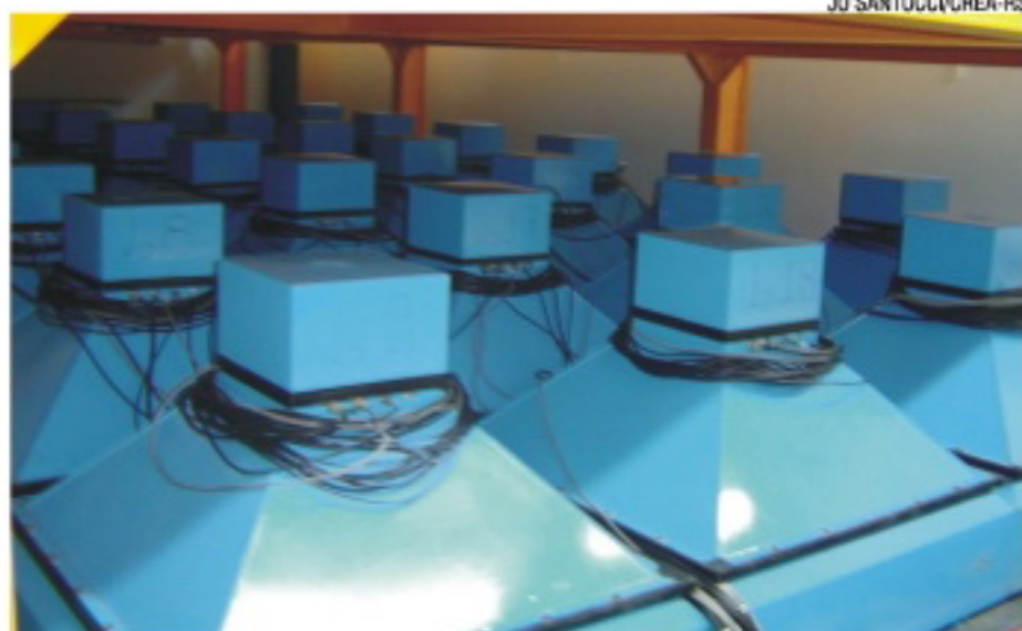
Detector de muons do Observatório Espacial do Sul
