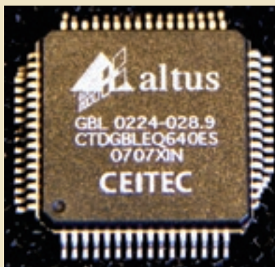
Chip: conjunto de componentes eletrônicos integrados em uma única peça de silício
