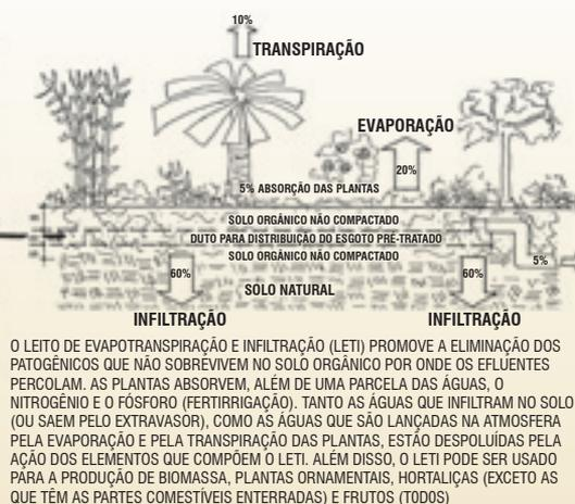
Os sistemas convencionais de coleta e tratamento de esgotos domiciliares apresentam níveis de eficiência técnica e econômica nem sempre compatíveis com a realidade de alguns assentamentos humanos. O Sistema Modular com Separação de Águas trata as águas servidas no local e permite o aproveitamento dos poluentes dessas águas na forma de insumos para a produção vegetal, devolvendo-as purificadas para o ciclo hidrológico, pela evapotranspiração e infiltração no solo, sendo
