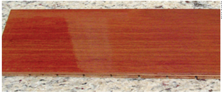
Piso de madeira com o isolante e o verniz aplicados
