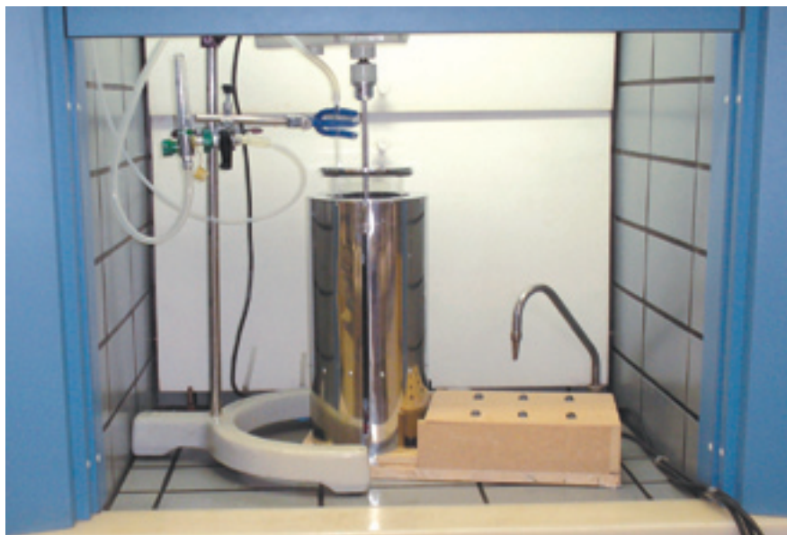
Reator de fotocatalise em escala laboratorial do Centro Petroquímico de Pesquisa e desenvolvimento (Ceppd) da Ulbra
