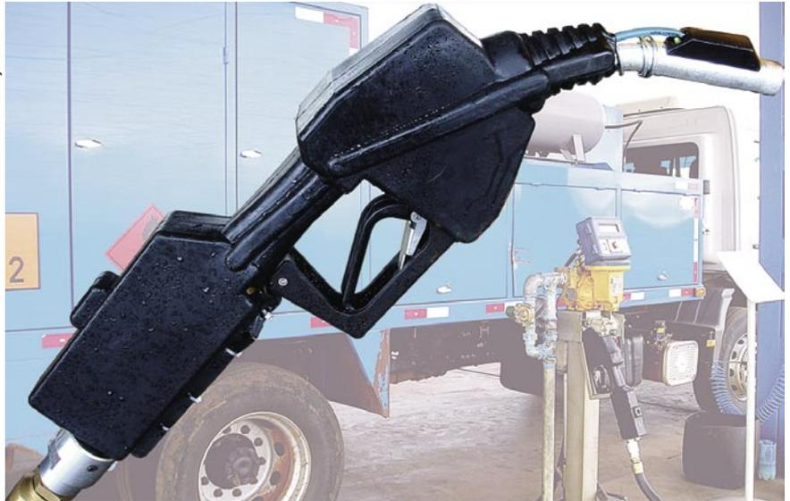
O leitor acoplado ao bico de abastecimento pode ser usado com qualquer combustível
