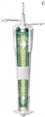
existe uma diferença marcante entre a tecnologia de ultracentrifugação desenvolvida no Brasil e aquela utilizada em outros países. O rotor da ultracentrífuga desenvolvida nesses locais gira apoiado em um mancal mecânico, tipo agulha, enquanto o rotor usado no Brasil gira levitando por efeito eletromagnético, o que elimina o atrito e, conseqüentemente, os desgastes, a manutenção e a quantidade de energia necessária ao funcionamento da ultracentrífuga.
