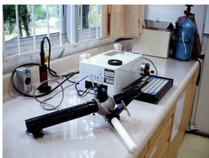
Laboratório conta com modernos equipamentos, como o da foto, um espectrorradiômetro LICOR-1800
