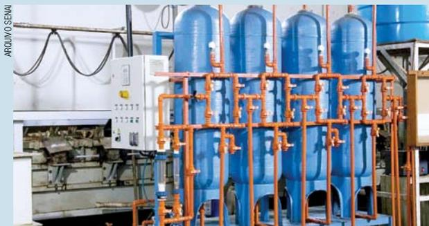
O novo equipamento permite a geração de em torno de 30 l/h de efluente e uma economia de 90% de água da rede
