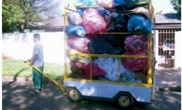
O contêiner aramado movimenta-se por um motor elétrico. Possui sistema de freios que inclui um freio de emergência e de estacionamento. O comando é eletrônico realizado pelo catador. A velocidade máxima é de 6 km/h, que corresponde ao passo rápido de uma pessoa
