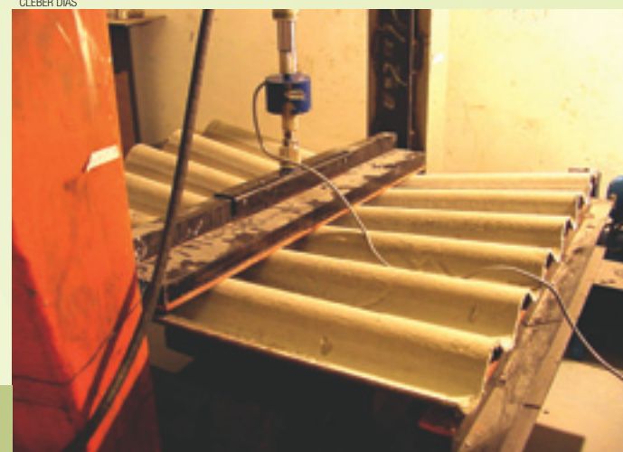
Telhas com novo tipo de fibrocimento
